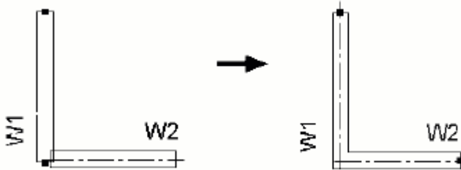
Bild 4: nachträgliche Punkt - Punkt - Verbindung
